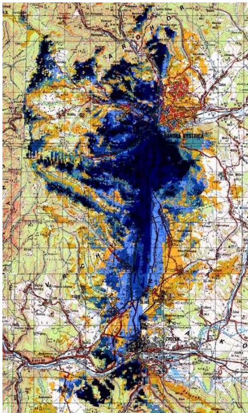
Obr. 4 – Vypočítané pokrytie územia z vysielača DVB-T na budove VÚS (TV kanál K27, ERP_{\max} = 200 \text{ W} )
